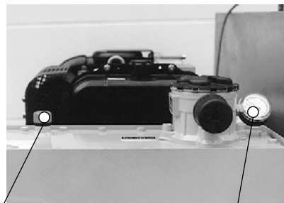
Указатель чистоты фильтра гидравлического масла (указатель должен быть на зеленом поле)
